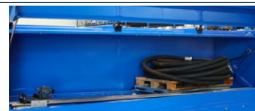
PLATFORM FOR TESTING HOSE COILS ON PALLET PIATTAFORMA PER COLLAUDO MATASSA DI TUBO SU PALLET
